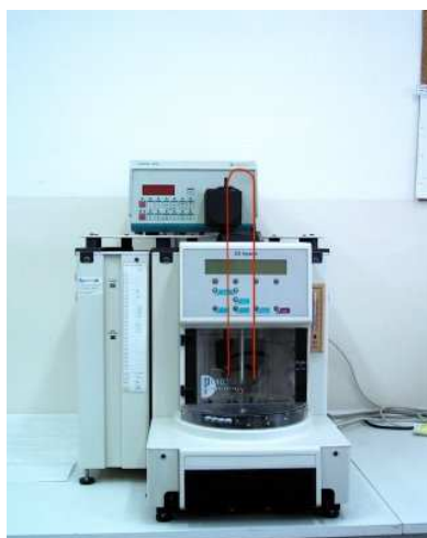
Rys. 7 Aparat do elektroforezy kapilarnej PrinCE (Prince Technologies, Holandia). Czerwoną linią zaznaczono przebieg kapilary.
